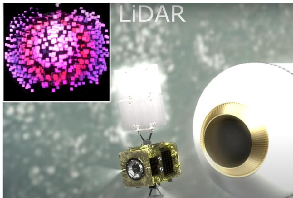
※1 LiDAR:「light detection and ranging」。レーザー光を照射し、物体に当たって跳ね返ってくるまでの時間を計測し、物体までの距離や方向を測定する。
